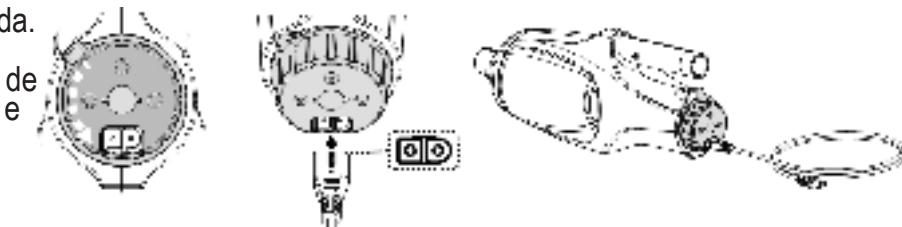
**Desligado/Carregamento** girando o botão de mudança no sentido anti-horário até parar e expor completamente a porta de carregamento. Alinhe e insira o cabo de carregamento USB na porta de carregamento.
